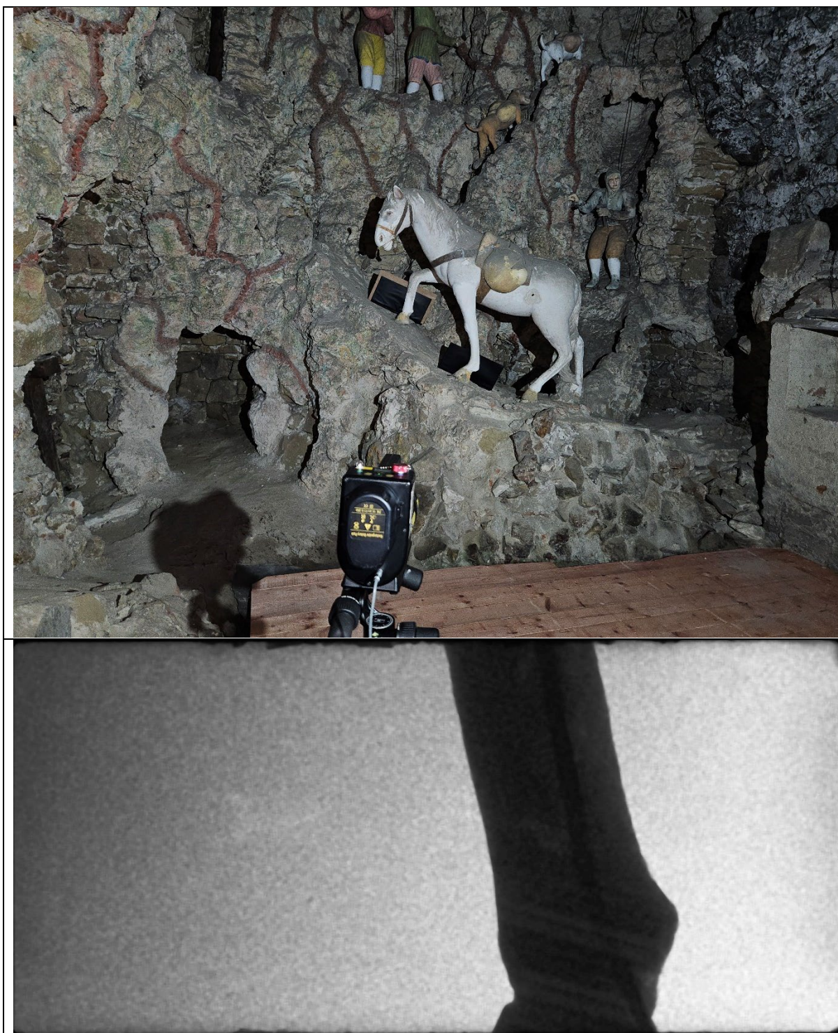
Obr. 24: Kůň – levá přední noha. Radiogram ukazuje, že se kovová kostra v místě kopyta dostává blízko k povrchu, což by mohlo vést k problémům s korozí.
