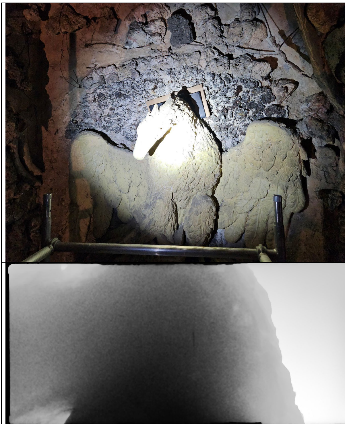
Obr. 26: Orlice – radiogram neukázal na přítomnost kovových výztuh, možná skrytých malým kontrastem vůči nakupení materiálu v hlavě a hrudi.
