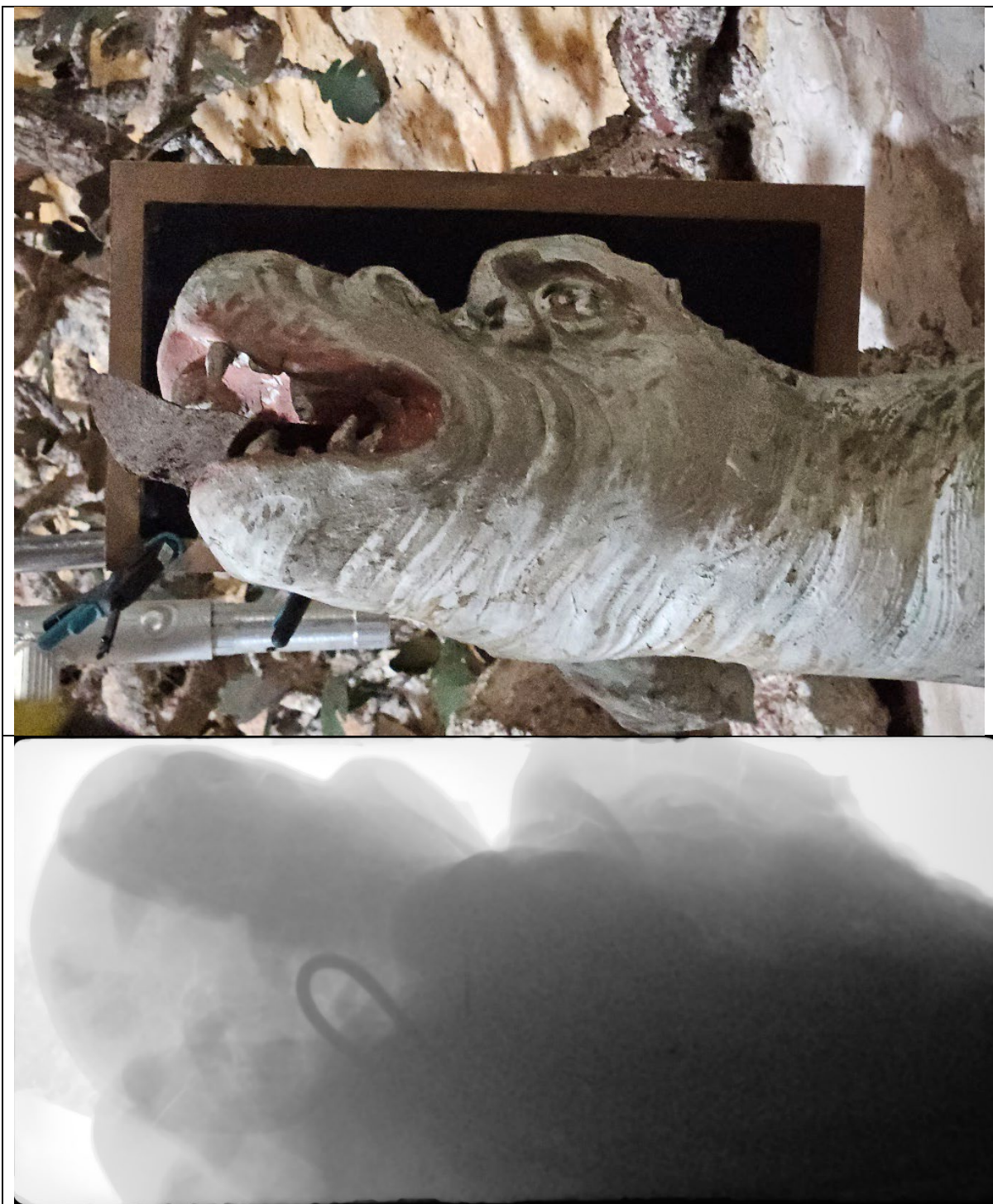
Obr. 3: Hlava draka s odpovídajícím radiogramem ukazujícím přítomnost vnitřní drátové kostry.
