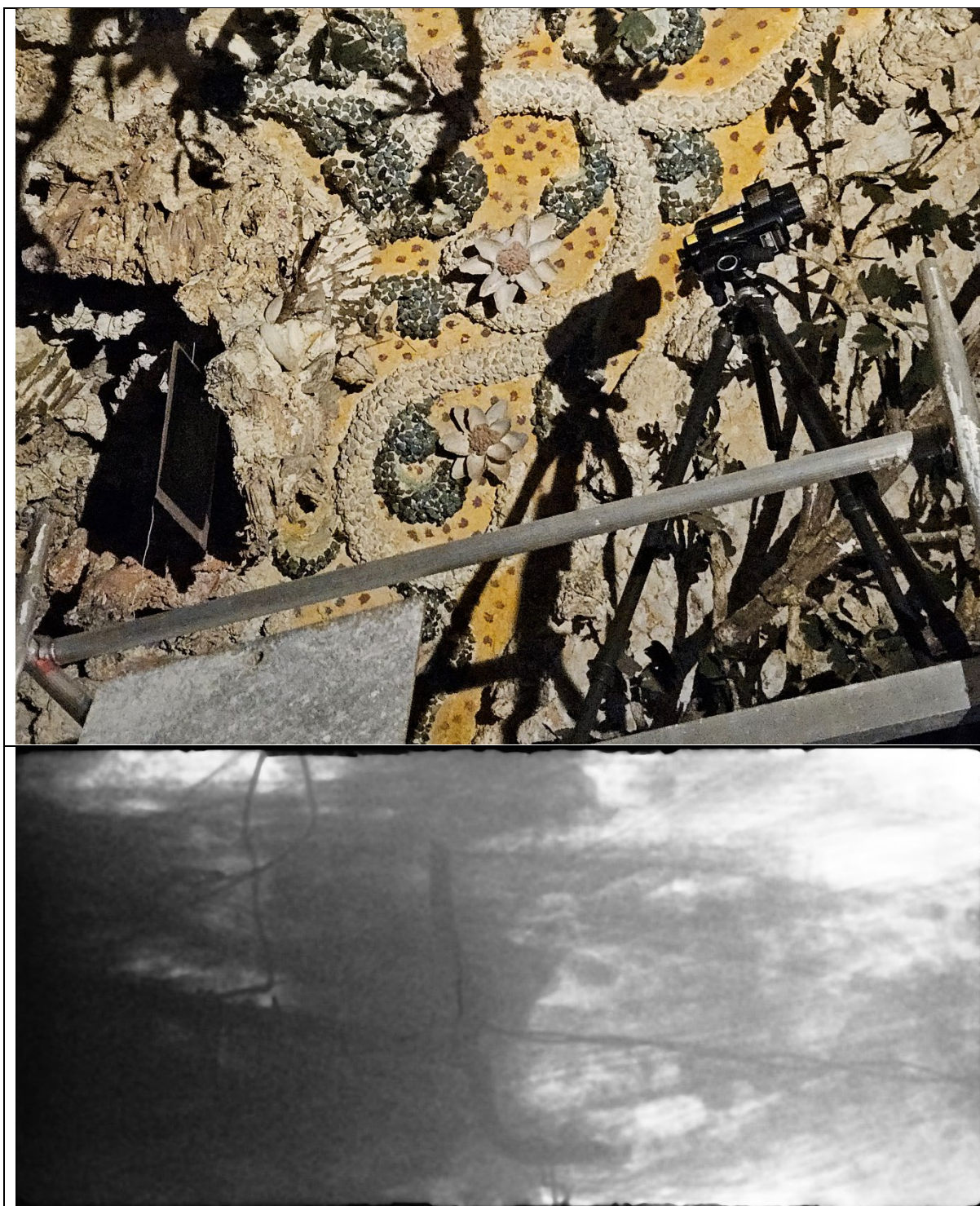
Obr. 25: Objekt visící u stropu před fontánou. Radiogram odhaluje složitý způsob kotvení prvku k soustavě drátů.
