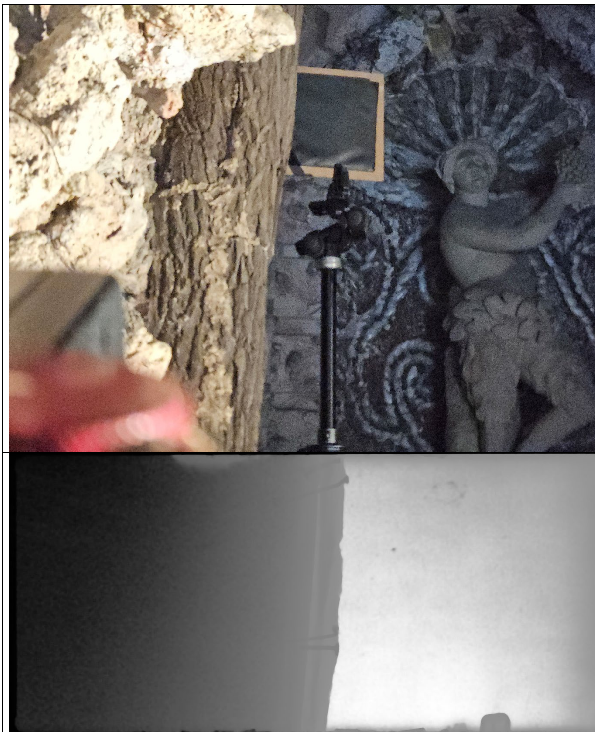
Obr. 9: Jiný detail kmene s odpovídajícím radiogramem a omezeným zobrazením vnitřní stavby objektu.
