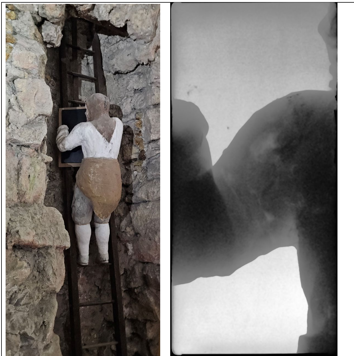
Obr. 11: Levé rameno horníka lezoucího po žebříku. Vnitřní výztuha je na radiogramu slabě viditelná jako diagonální linie jdoucí z levé horní části do pravé spodní části.
