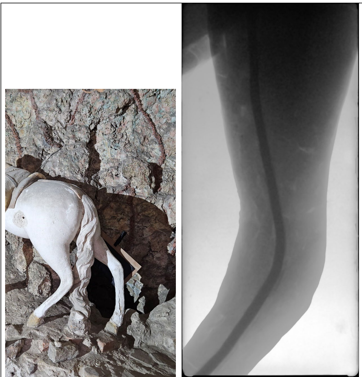
Obr. 19: Střední část pravé zadní nohy koně – kontrastní světlá místa mohou indikovat přítomnost trhlin.
