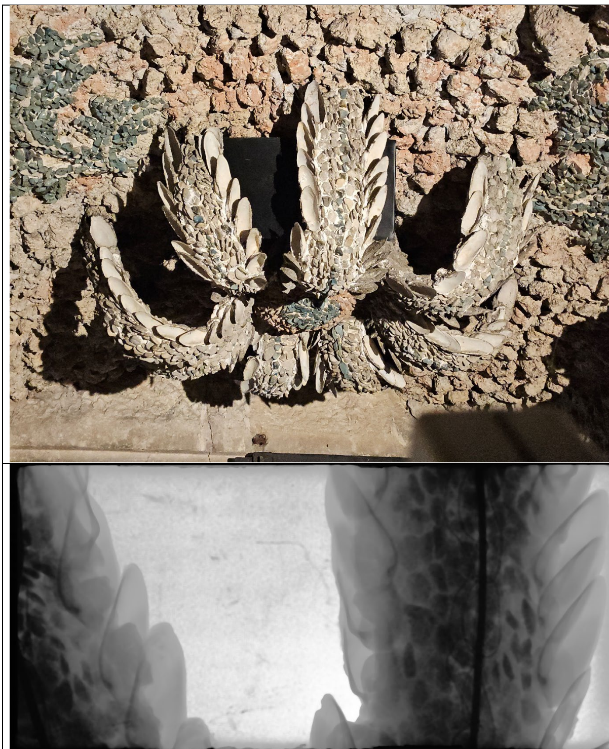
Obr. 10: Květ nad vstupem do grotty. Kontrast v radiogramu zvýrazňuje přítomnost dekorativních kamínků a mušlí, ale také pomocné konstrukce z tenkých drátků.
