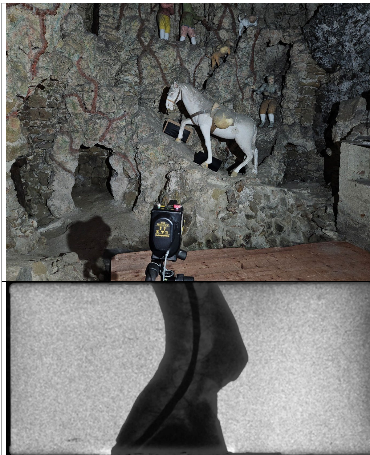
Obr. 23: Kůň – pravá přední noha, z radiogramu lze tušit, že drátová kostra byla obalena před konečnou vrstvou štuky materiálem, který tolik nepohlcuje rtg záření.
