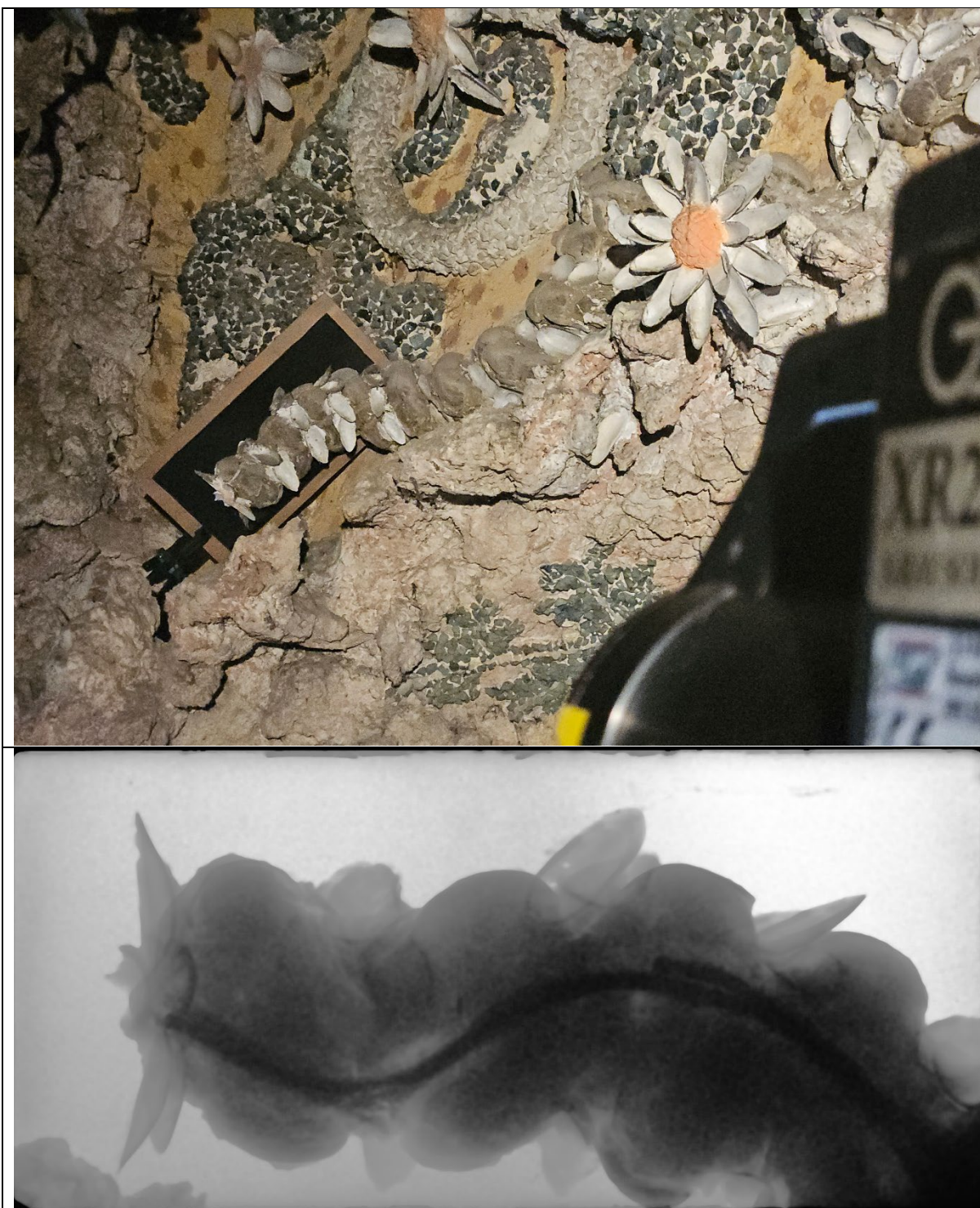
Obr. 6: Vnitřní struktura fantazijní květiny tvořené kombinací štuku a mušlí včetně radiogramu.
