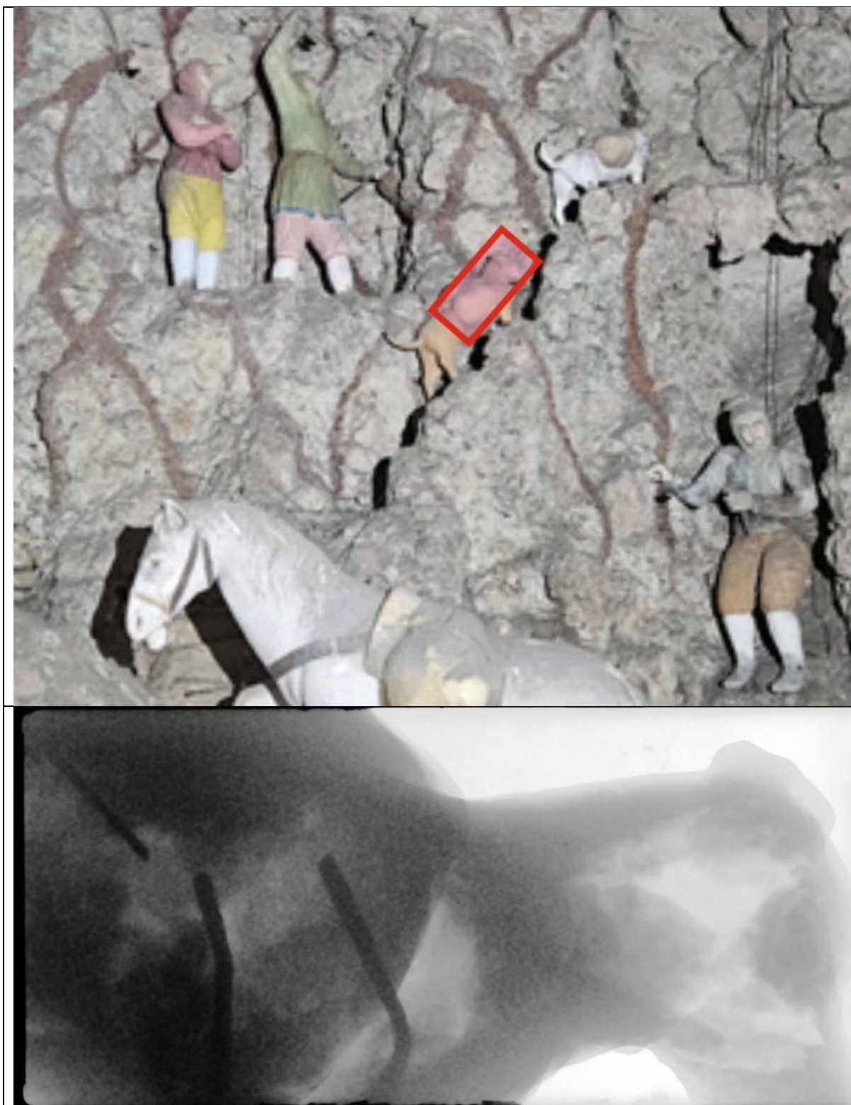
Obr. 15: Přední část pejska-nosiče. Radiogram ukazuje řešení armatur shodné se zadní částí.
